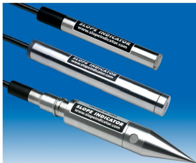
Figura 3.1 Piezómetros. Em cima, o instrumento mais comum, usado para a generalidade das aplicações; a meio, o sensor adaptado para baixas pressões; abaixo, o sensor push-in com um formato mais otimizado para argilas moles. Retirado de (DGSI, 2019b).
