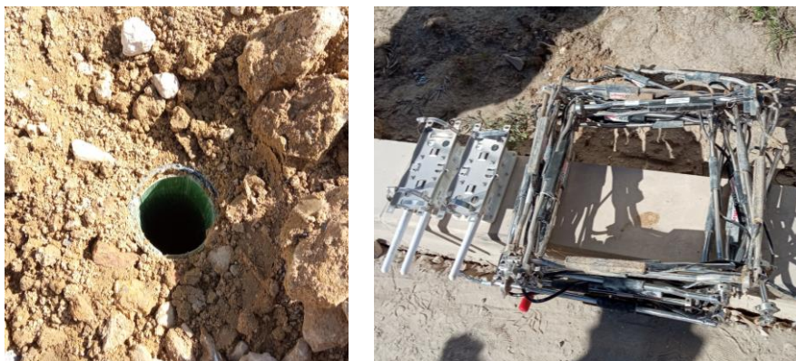
Figura 6.15 Inclinómetro in place e a calha inclinométrica onde estava inserida a série de inclinómetros na Zona Instrumentada 1.
