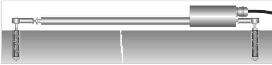
Figura 3.13 Fissurômetro de corda vibrante. Retirado de (DGSI, 2017).
